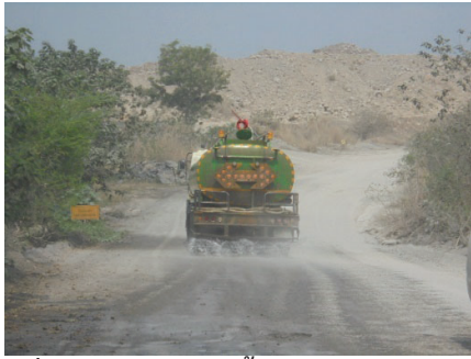
รูปที่ 2-9: การฉีดพรมน้ำบนเส้นทางขนส่งแร่
