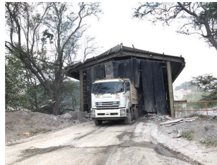
รูปที่ 2-4: การปิดคลุมถังรับแร่
