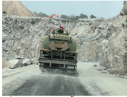
รูปที่ 2-10: การฉีดพรมน้ำบริเวณหน้าเหมือง
