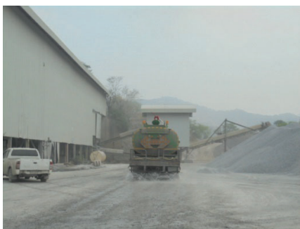
รูปที่ 2-7: การฉีดพรมน้ำบริเวณโรงโม่หิน
