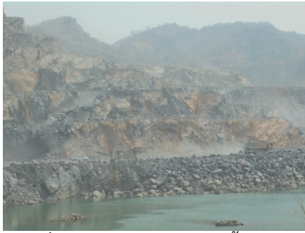
รูปที่ 2-1: การทำเหมืองแบบขั้นบันได
